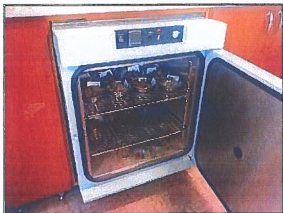
Figura 3.4.5. Uscarea probelor în etuvă
