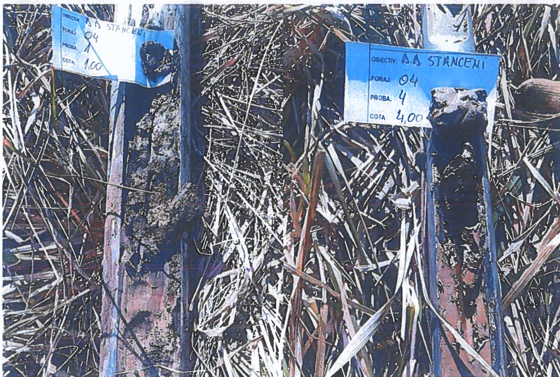
Figura 4.3.4. Realizare foraj și prelevare probe – Foraj geotehnic f04
